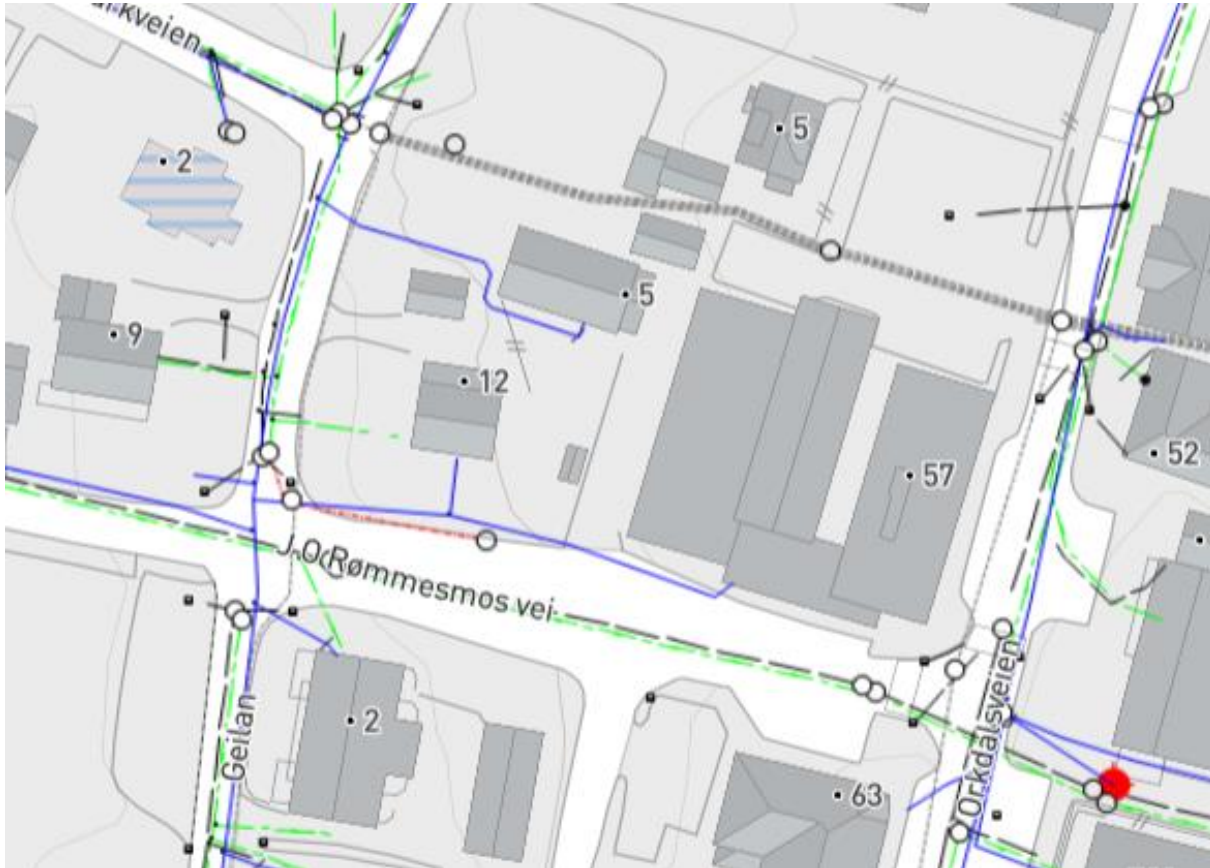
Bilde: 7: Bildet viser utklipp fra kommunens kartdatabaser for hvor overordnet vann- og avløpsledninger ligger. Grønn strek: Spillvannsledninger. Blå strek: vannledning. Kilde: Orkdal kommune.
