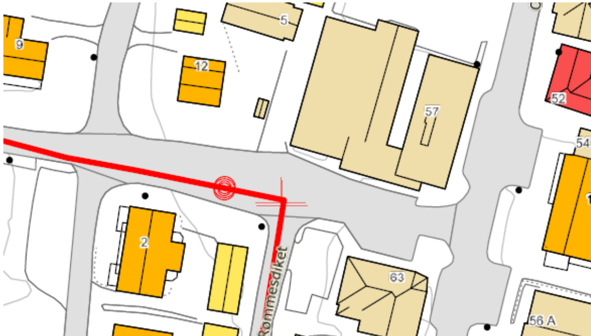
Bilde: 6. Rød strek på bildet viser hvor fjernvarmerørene ligger i forhold til prosjektet. Kilde: Orkland energi
